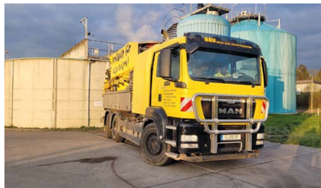
Abb. 4: Der mobile Schlammtransport
