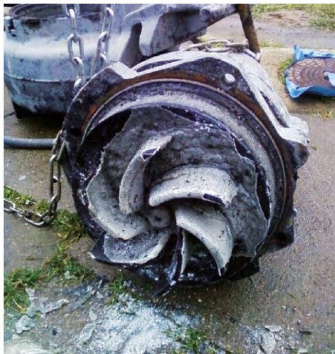
Abb. 2: MAP-Inkrustationen am Laufrad (Foto: Stadtentwässerung Langenhagen)
