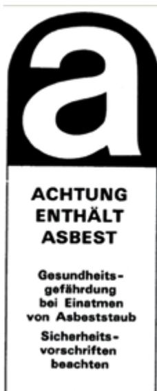
Abb. 1: Kennzeichnung asbesthaltiger Erzeugnisse (REACH-Verordnung 2018)
