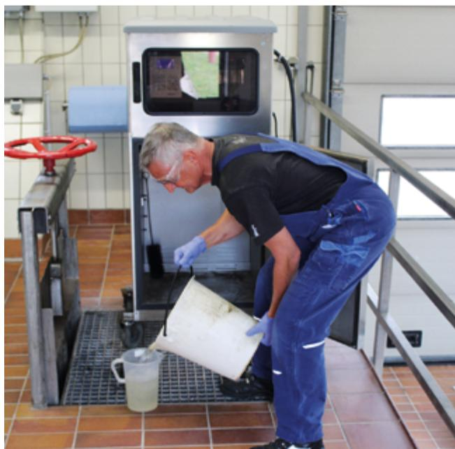
Abb. 2: Umfüllen einer kleinen Probemenge
