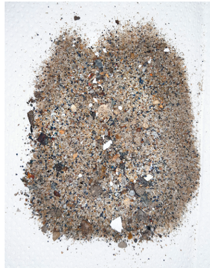
Abb. 9: Sand aus der Zentrifuge
