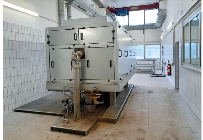
Abb. 2: Die Zentrifuge unter der Schallhaube – eine aufgeräumte Sache
