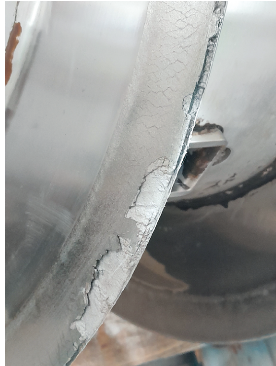
Abb. 12: Abplatzungen an der Wendel
