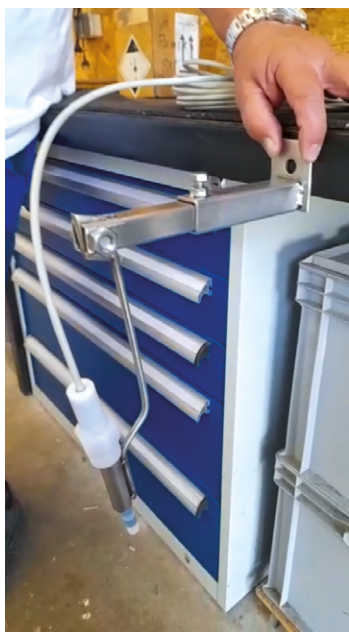
Abb. 1: Die bewegliche Sondenhalterung, fertig für die Montage im Übergabeschacht
