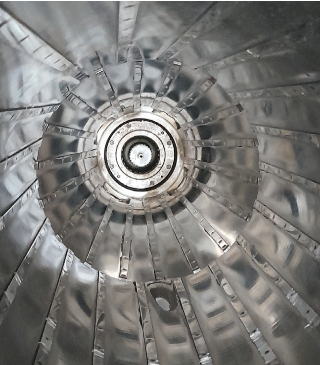
Abb. 10: Die Riefen in der Trommel sind gut zu erkennen
