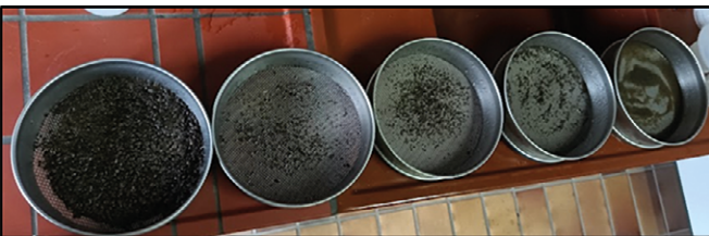
Abb. 5: Nasssiebung des granularen Schlammes (Siebgrößen von links 1,8 mm, 1,4 mm, 1,0 mm, 0,6 mm, 0,2 mm)
