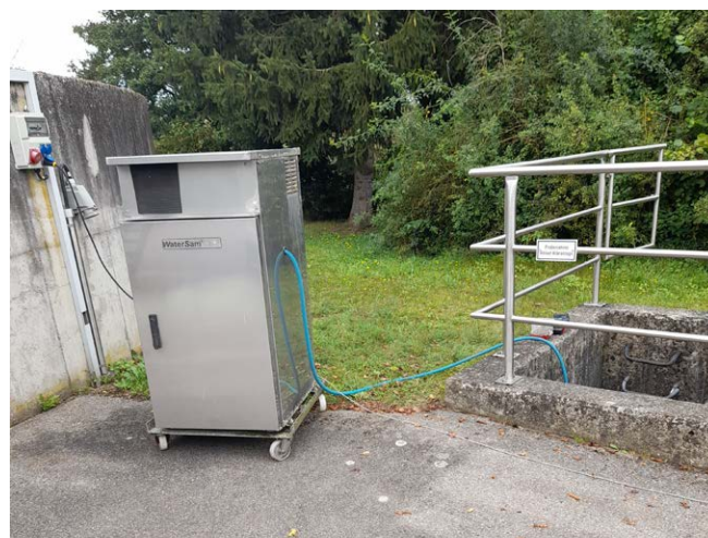
Abb. 5: Probenehmer für 24 Stunden Probenahme
