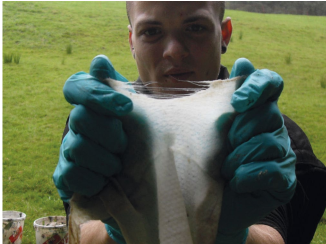
Abb. 4: Zerreißen nur mit großem Kraftaufwand
