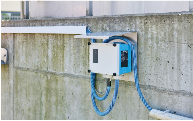
Abb. 2b: Die angesaugte Probe wird über die im Gehäuse untergebrachte Schlauchpumpe und beheizte Schläuche zu den im nahegelegenen Gebäude untergebrachten Messgeräten befördert.
