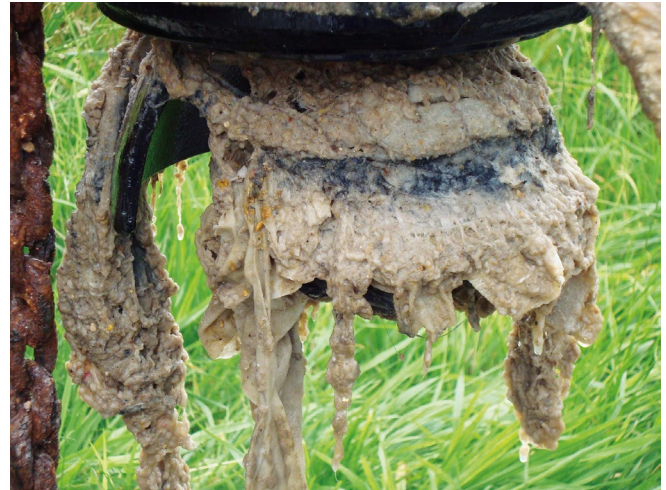
Abb. 3: Bei der Pumpe geht gar nichts mehr.
