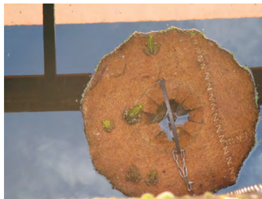
Abb. 6: Materialtest für den Bau einer Rettungsinsel aus einer Kokosnussmatte. Später wird noch ein Fangbehälter in der Mitte installiert. (Foto: Abwasserzweckverband Breisgauer Bucht)
