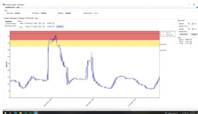
Abb. 11: Graphische Auswertung der Schlammvolumenbeschickung. Deutlicher Anstieg bei einsetzendem Mischwasserzufluss
